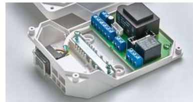
Фото 6. Блок управления со снятой крышкой. Отверстия для ввода в блок питания кабелей и планка (на двух винтах) для их крепления
